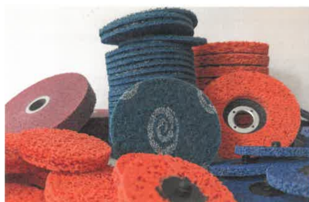
Vlies-Schleifmittel (Non-Woven) bestehen aus nicht gewebten synthetischen Nylonfasern, die mit schleifenden Mineralstoffen wie Aluminiumoxid, Keramik Korn oder Siliziumkarbid und mit Kunstharzen imprägniert sind. Foto: Saint-Gobain Abrasives GmbH
